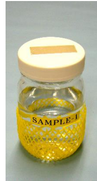
②サンプル容器に試料 300mL 採水 (土壌溶出試験の場合は土 30g 計量)
