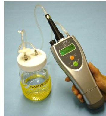
⑤チューブを差込み吸引測定 (約 10~20 秒間)
