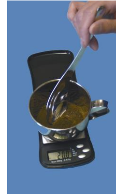
②サンプル容器に試料 300mL 採水 (土壌溶出試験の場合は土 30g 計量)
