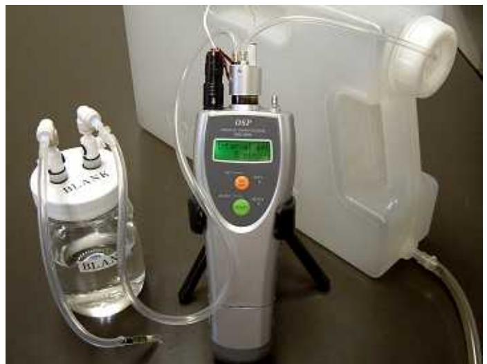
写真3 バルブヘッドによる水中 VOC のインターバル測定
