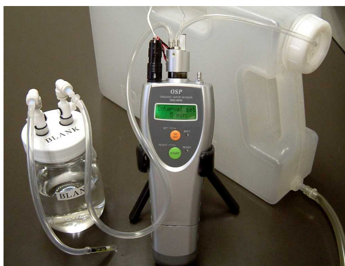
写真 3 バルブヘッドによる水中 VOC のインターバル測定
